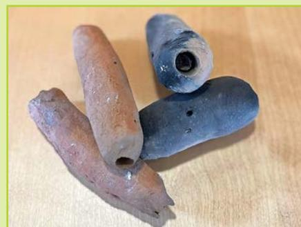
Zurück bleibt ein Hohlraum, der im Anschluss mit Bronze ausgegossen werden kann.
