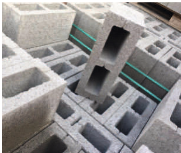
Leichtbeton-Hohlblöcke für die Verwendung im Mauerwerksbau
