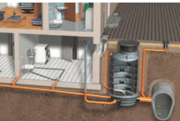
Rückstausicherung außerhalb des Gebäudes
